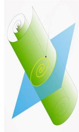
Figura 4. In figura si può vedere la struttura mineralogica del crisotilo fatta dalla sovrapposizione di ottaedri O e tetraedri T che vanno a formare dei fogli, con successivo arrotolamento degli stessi.
