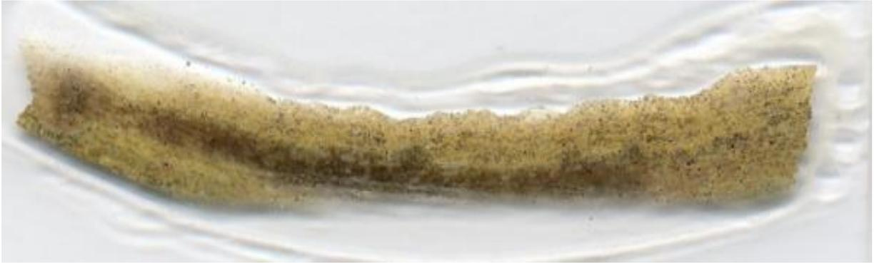
*Figura 29. Sezione sottile del pannello inertizzato Firenze Via Lulli. Sono ben distinguibili due zone a colorazione diversa, una centrale scura ed una esterna più chiara.*
