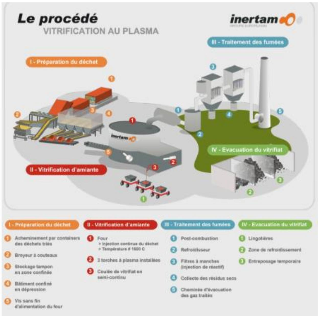
Figura 11. Schema dei componenti principali dell'impianto al plasma di INERTAM
