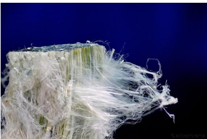
Figura 6. Fascio di fibre di crisotilo, detto anche amianto bianco. Il campione fa parte di una vena monomineralica all'interno di una serpentinite massiva.
