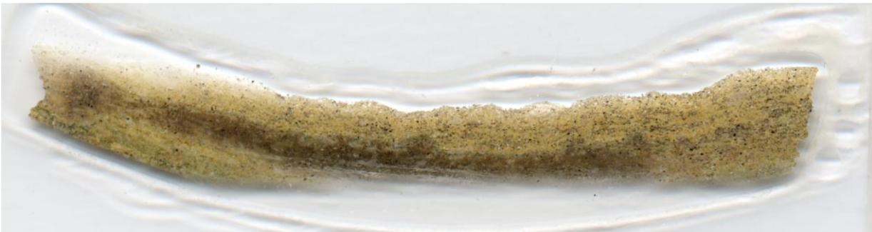
Sezione sottile del pannello inertizzato. Si osserva una colorazione non omogenea del pannello, con una zona centrale di colore più scuro. La sezione è stata analizzata tramite SEM/EDS.
